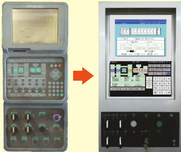
レトロフィット後のコントローラ名称 → SYSCOM1000 Mark3
