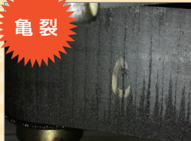
▲ベルト表面に亀裂が
