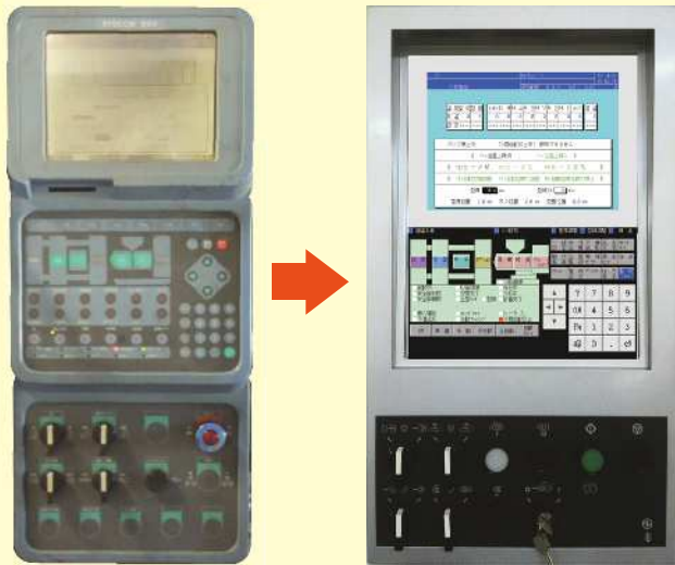
レトロフィット後のコントローラ名称 → SYSCOM1000 Mark3
