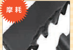
▲側面に摩耗損傷が
