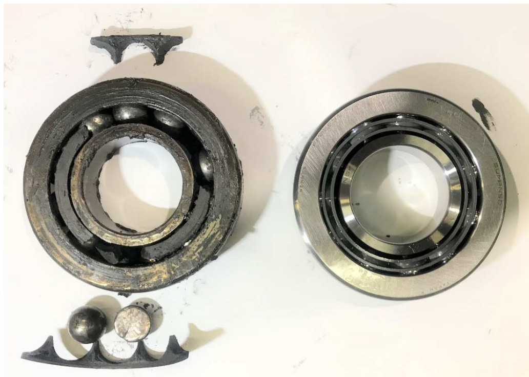
写真：給脂不足により破損したベアリング（左）と正常品（右）
