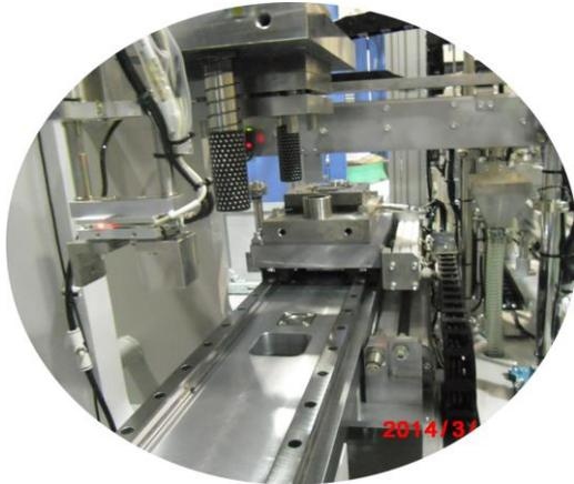
板状インサートワーク成形後に、成形品内部の板状インサートワークを規定の形状にプレス加工しています
